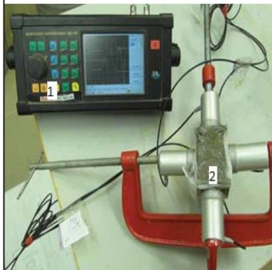
Измерения теплофизических характеристик грунтов производились методом монотонного режима на приборе «ИТС– $\lambda$ с–10» (фото 3). Монотонным режимом сейчас принято называть такой режим разогрева-охлаждения образцов, при котором в опыте внутри образца одновременно сохраняются малыми температурные перепады и почти равномерное поле скоростей изменения температуры. Монотонный режим по своей физической сути явился существенным обобщением квазистационарного и регулярного режимов [3, с. 6].
