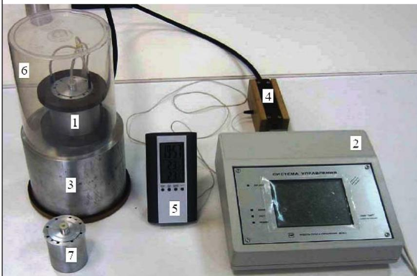
Конструктивно прибор «ИТС–λс–10» выполнен в виде двух блоков: теплоизмерительной ячейки и специализированного электронно-вычислительного устройства – теплофизического контроллера (ТФК). Один из металлических блоков размещается на рабочем столе, при комнатной температуре, а второй блок – в морозильной камере, при заданной отрицательной температуре.
